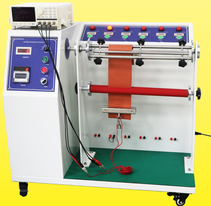
弯曲试验中的柔性硅胶加热器
